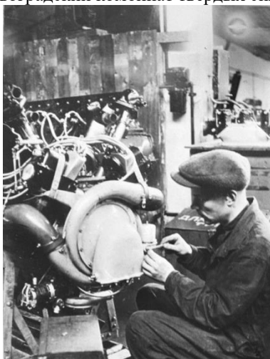
Рисунок 14 – Сборка авиационного двигателя на заводе № 26 в Уфе
