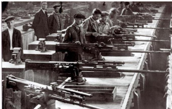
Рисунок 6 – Производство 23-мм авиационной пушки Волкова-Ярцева на Златоустовском машиностроительном
