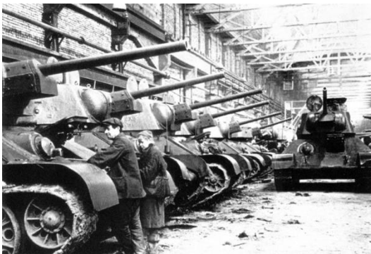
Рисунок 12 – Регулировка механизмов танков в цехе сдачи боевых машин Уральского танкового завода № 183 в Нижнем Тагиле
